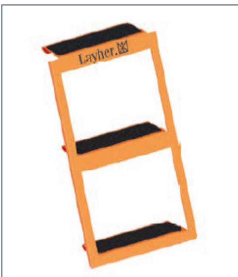
Stufeneinhängetritt aus qualitativ hochwertigem Stahl, mit einem Eigengewicht von ca. 3 kg. Pulverbeschichtet mit einer Materialstärke von 2,5 mm. Der Stufeneinhängetritt rüstet gleich 3 Stufen auf einmal nach.
