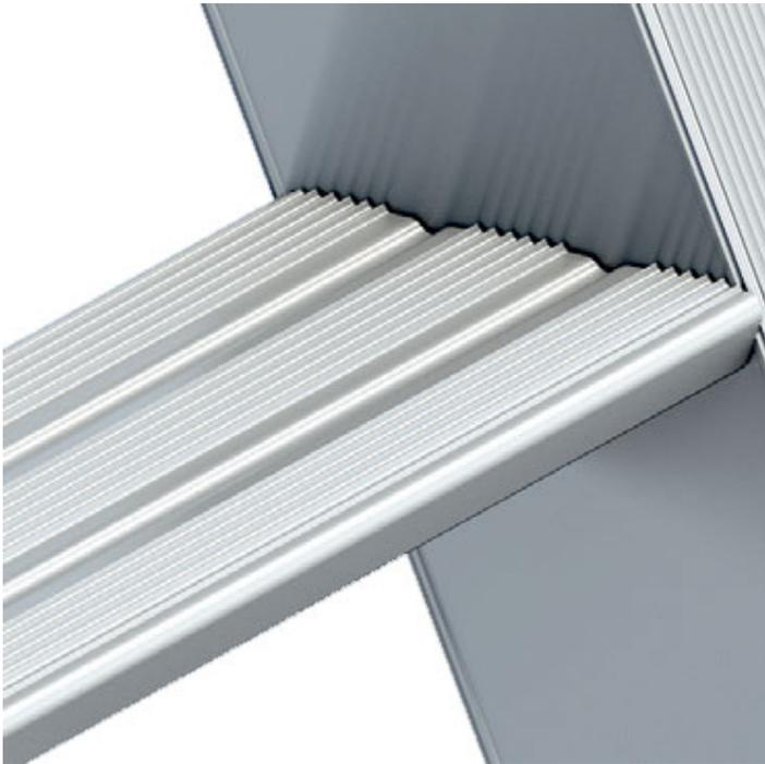
Stufen aus hochfesten Strangpressprofilen ohne Längsschweißnaht mit hoher Beanspruchbarkeit. Diese sind in den Holmen 4-fach verpresst. Die Form der Dreikantsprosse sorgt für Verdrehsicherheit, die Verpressung für eine hohe Seitenstabilität der Leiter. Für ein hohes Maß an Trittsicherheit sorgt die stark geriffelte Trittfläche der Stufen.
