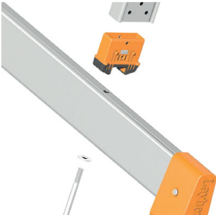
Combigrip-Leiternfuß aus rutschsicherem Kunststoff für einen sicheren Stand der Leiter und eine schnelle Montage und Demontage der Traverse mit nur einer Schraube je Leiternfuß.
